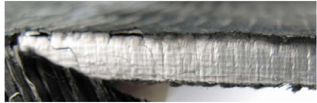
BILD 6. Versiegelte Schnittkante einer laserbesäumten Preform
