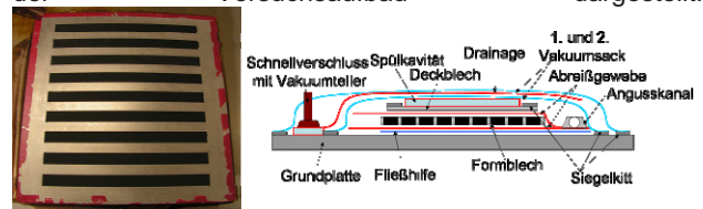
BILD 10. Versuchsaufbau für eine endkonturnahe Injektion
