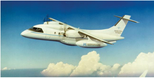
BILD 4. Bei einer Studie zur wasserstoffgetriebenen Do 328 waren die Wasserstofftanks in Gondeln unterhalb des Flügels angebracht [12]
