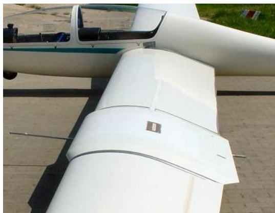
BILD 2. Segelflugzeug mit aufgeschobenem Versuchshandschuh
