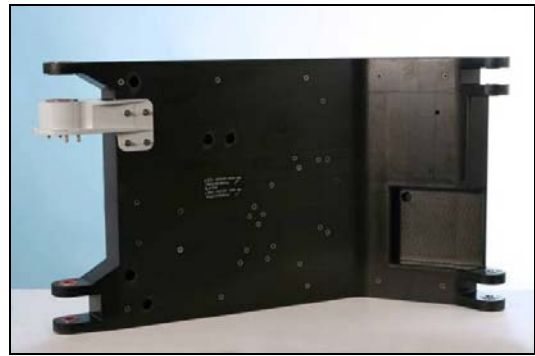
BILD 10. Ausgespülter kernloser Traglenker
