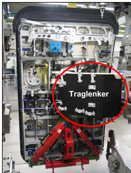
BILD 2. Traglenker im Einbauzustand an der Flugzeugtür
