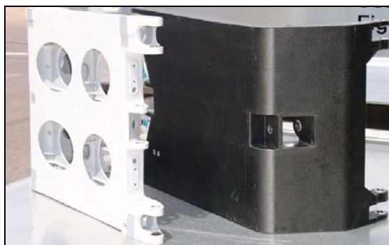
BILD 3. Aluminium- und CfK-Traglenker mit integrierten
