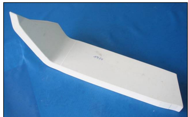
BILD 7. Ausgehärteter Kern, unversiegelt
