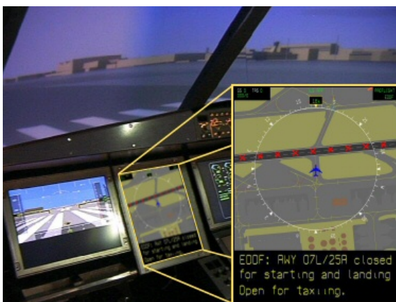
Bild 8: TUD Cockpit Simulator, hervorgehoben die Airport Moving Map Anzeige mit einer temporär geschlossenen Start-/Landebahn
