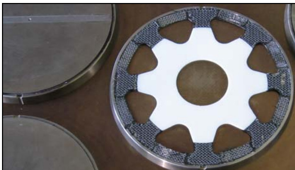
BILD 7. Werkzeugbelegung Trockenpreform und Schaum
