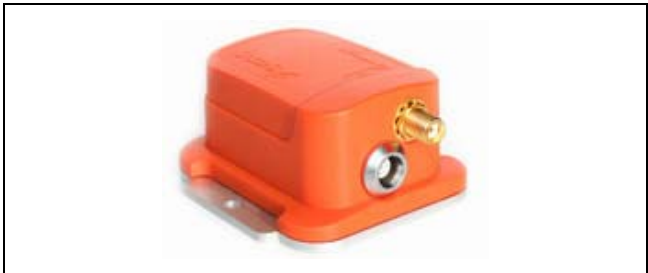
BILD 2. Kommerzielle Sensorik (MTi-G, XSens) des Systems
