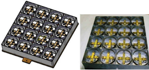
BILD 1. 3D-Modell und Fotografie der CFK LISA
