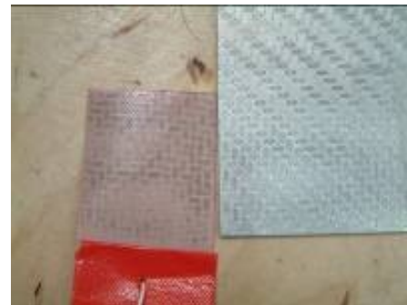
BILD 18. Gute Haftung zwischen Metallisierung und CFK
