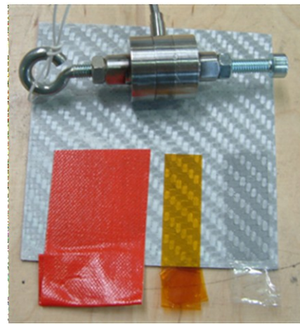
BILD 17. Aufbau des Peel-Off-Tests
