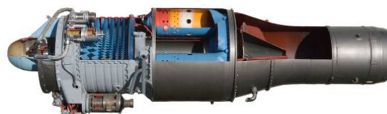
Abb.3: Bristol Siddeley Orpheus (Schnittmodell)
