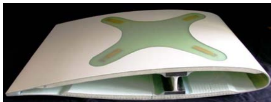
BILD 18. Flügeldemonstrator mit einlaminieren Faserwandlern (Fraunhofer LBF,ISC, IZFP-D)
