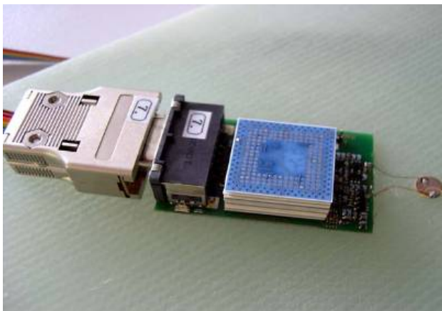
BILD 15. Sensorauswerteelektronik gestapelt IZFP-D, RHe
