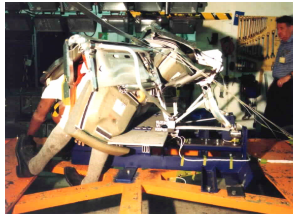
BILD 13. Erster 16g Vorwärtsversuch bei RECARO
