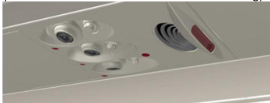
Bild 18: PSU – Individuallicht für den Passagier: Leseleuchte – Signs – Steward Call
