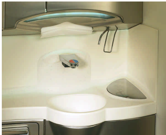
Bild 22: Waschtisch, Wasserhahn und Waste
