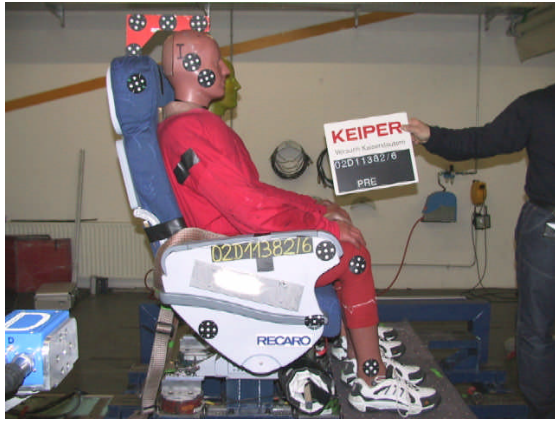
BILD 12. Versuch zur Ermittlung des Kopfkreises
