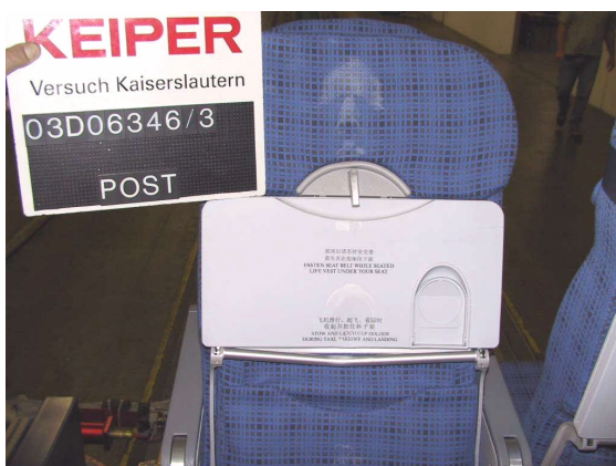
BILD 7. Auftreffbereich im oberen Teil der Rückenlehne (Gesichtabdruck auf Bezug)
