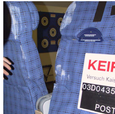
BILD 9. Auftreffbereich Außenkante Rückenlehne – Hinteres Ende Armlehne
