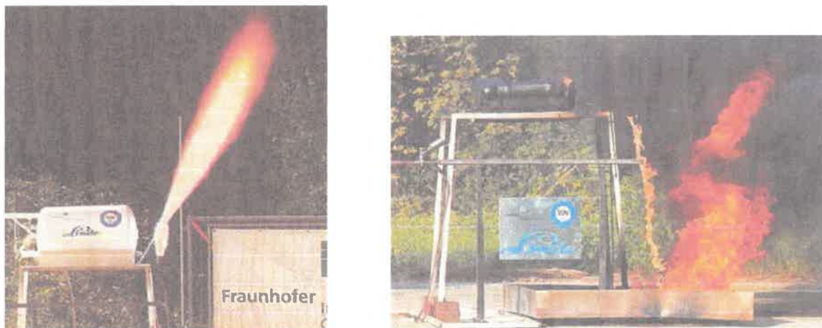
Bild 2.7 Tankleckage – Vergleich Wasserstoff und Benzin (Neumann 2003)
