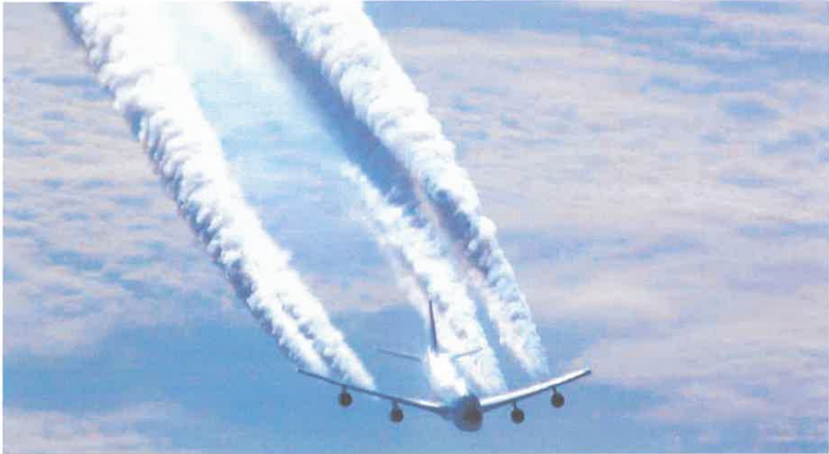
Bild 2.10 Kondensstreifen-Bildung auf Partikeln im Abgas oder der Umgebungsluft (Schuhmann 2008)
