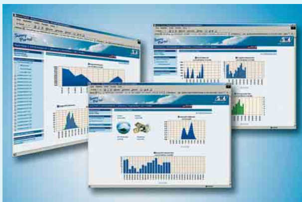
③ Moderne Kommunikationstechniken ermöglichen es, Wechselrichterdaten an eine Internet-Datenbank zu schicken und sie dort auswerten und visualisieren zu lassen.
