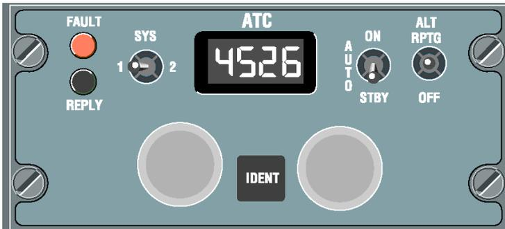
Die Stellung des Schalters bedeutet Altitude Reporting. Das bedeutet, dass der Transponder neben dem eingestellten Transponder Code auch die Flughöhe übermittelt.
