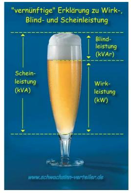
Die Leistung der Generatoren wird als Scheinleistung in kVA angegeben. Der Generator darf nur bis zu der angegebenen Scheinleistung belastet werden. Die Größe der Blindleistung und der Wirkleistung hängt vom Verbraucher ab (Induktivität oder Kapazität).
