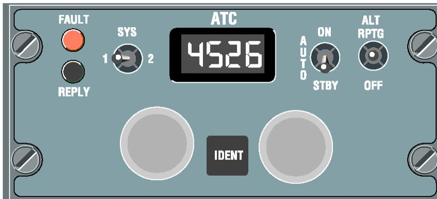
Es handelt sich um das Panel zum Transponder im Flugzeug. Der Pilot stellt die von der Flugsicherung vorgegebenen 4 Ziffern (den Transpondercode) ein. Damit erhält der Fluglotse ein Sekundärsignal auf seinem Radarschirm und kann damit die zu überwachenden Flugzeuge besser unterscheiden.
