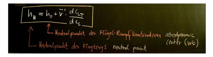
Definition: modifizierter Leitwerksvolumen beiwert modified tail volume coefficient
