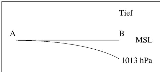
Hier wurde der Höhenmesser in A bei einem Druck von 1013 hPa auf 0 ft eingestellt. In B befindet sich das Flugzeug nach der Landung in Meereshöhe (MSL) *über* der Druckfläche von 1013 hPa. **Der Höhenmesser zeigt einen positiven Wert an.**
