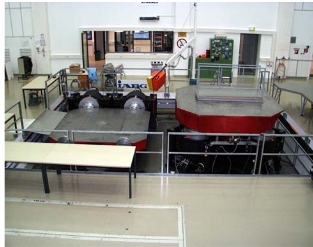
FIG 1. 300kN Vibration System (IABG)
