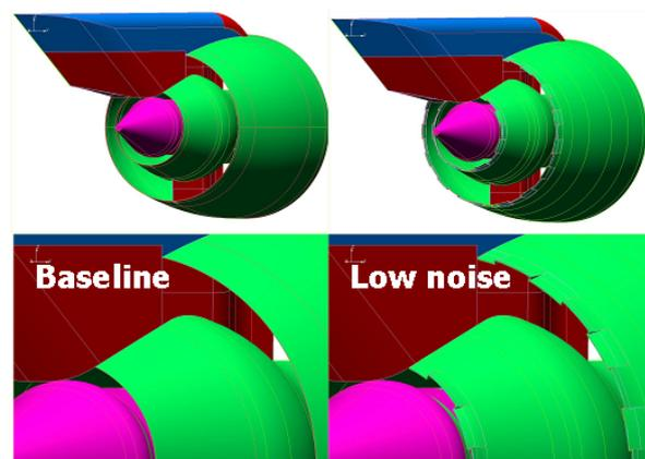
Fig. 2 : SILENCE® BPR9 nozzles
