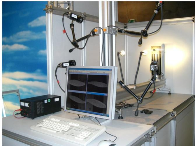
Fig. 2. DLR Strainmaster System
