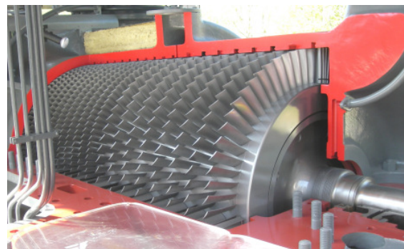
Abb. 5: Axialverdichter der ersten Kraftwerksturbine von BBC, 1939.
