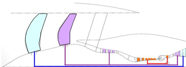
FIG 2. Counter rotating fan
