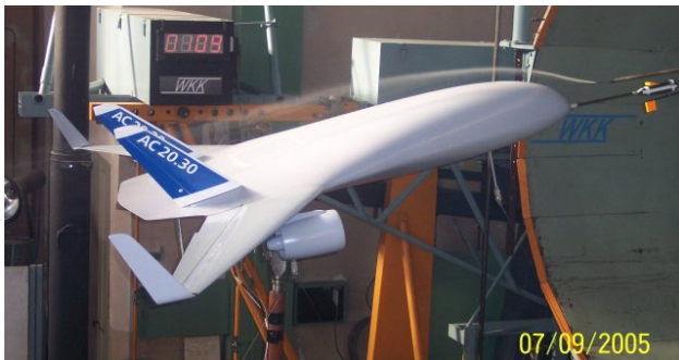
Bild 3: Untersuchungen mit einer Rauchfadensonde
