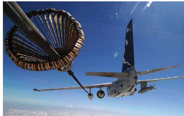
Bild 3 Fangtrichter zur Luftbetankung [10]
