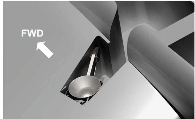
Bild 7 Montage der Schnittstelle Flügelfahrwerk
