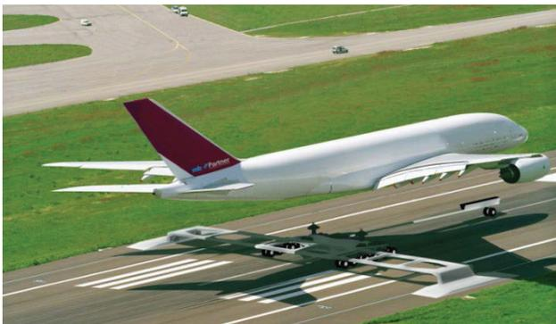
Bild 1 Derzeitiges Konzept vom bodengebundenem Fahrwerkssystem GroLaS
