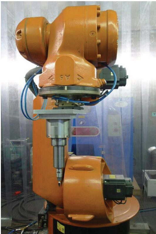
BILD 16. pneumatisch gelagerte Frässpindel zum maschinellen Kantenverrunden auf einen Roboter montiert
