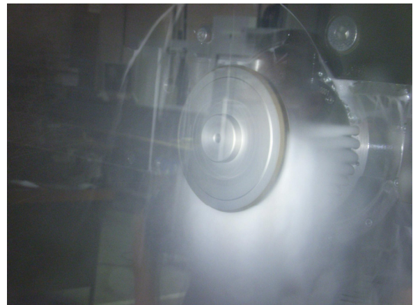
BILD 17. Innengekühlte Schleifscheibe – Spritzprobe zeigt einen im Eingriffsbereich konzentriert austretenden Kühlmittelstrahl (heller Bereich)
