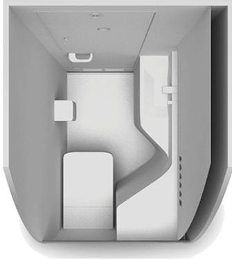
Bild 4: Monument mit 37" Breite in der Boarding Phase (voll funktionsfähig)
