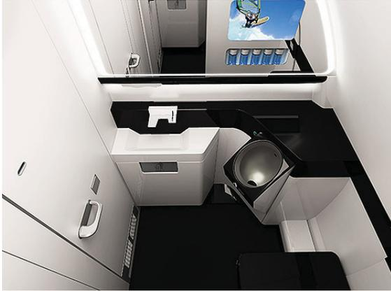
Bild 10: Integriertes Urinal
