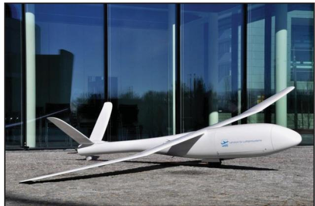
BILD 1. Der unbemannte Versuchsträger IMPULLS (Innovative Modular Payload UAV – Lehrstuhl für Luftfahrtsysteme)
