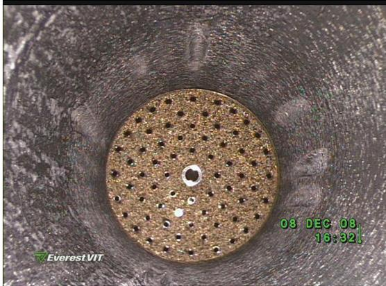
BILD 6 Endoskopische Aufnahme vom einspritznahen Bereich der KT-Brennkammer (C/C Liner) nach der KSK-KT-Kampagne
