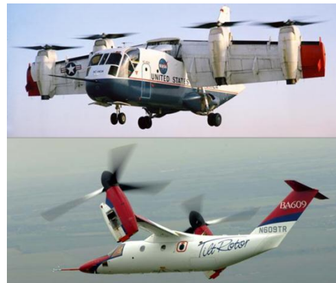
Abbildung 1: Kippflügelflugzeug XC-142A [8] –oben, Kipprotorflugzeug BA609 –unten [9]
