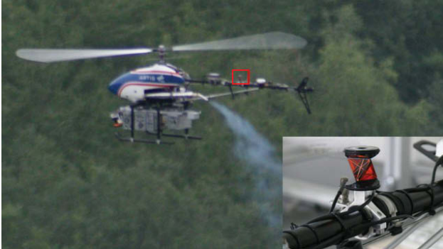
BILD 1: ARTIS-Hubschrauber mit Leica-Reflektor. Rotordurchmesser 1,9 m, Abflugmasse bis 15 kg, Nutzlast 6 kg.
