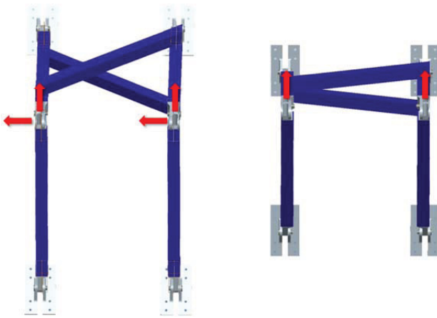
Bild 15: Kritischer Lastfall links: seitliche Belastung, kritischer Lastfall rechts: maximale Last in X-Richtung
