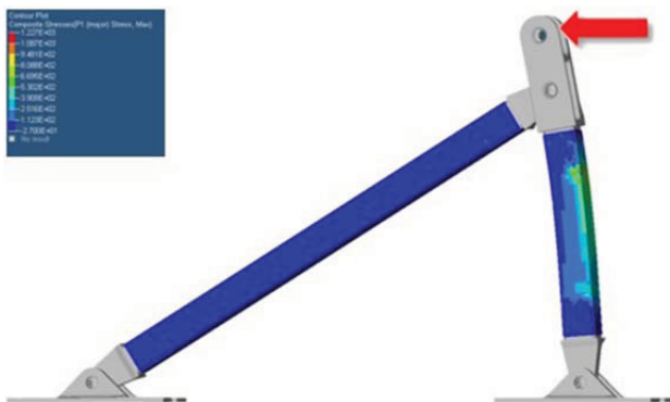
Bild 18: Realistische GFK-Zugspannungen bei Modellierung der kinematischen Kopplung des Mehrkörpersystems.
