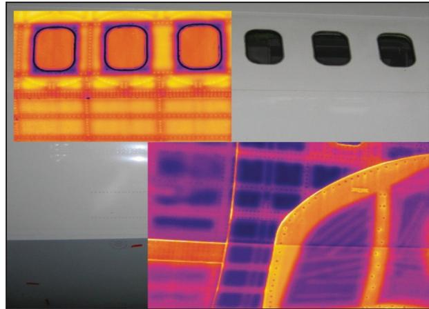
BILD 4. Aufnahme der Temperaturverteilung an einem Flugzeugumpf [7]
