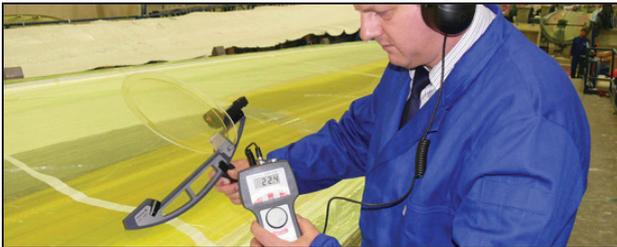
BILD 2. händische Leckagesuche mittels Ultraschallsensoren [2]
