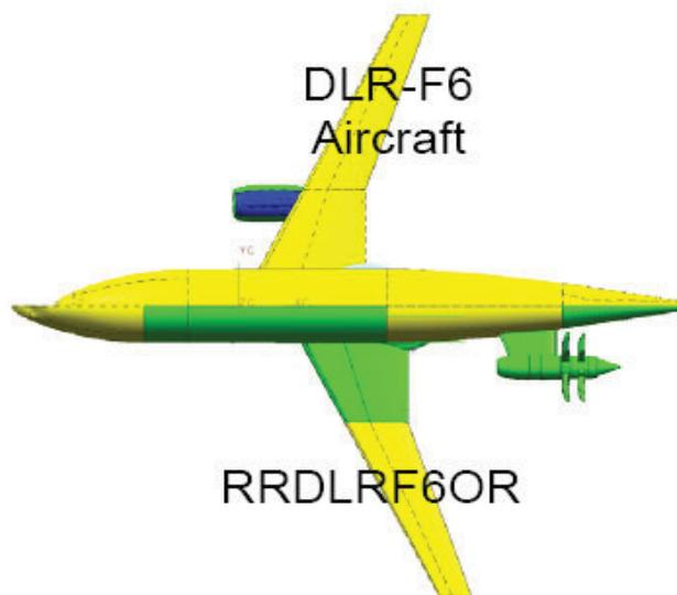
BILD 17: DLR-F6 Flugzeugmodell mit CROR in Heckinstallation
