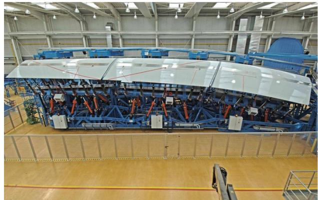
BILD 1. High Lift Systemprüfstand A380
