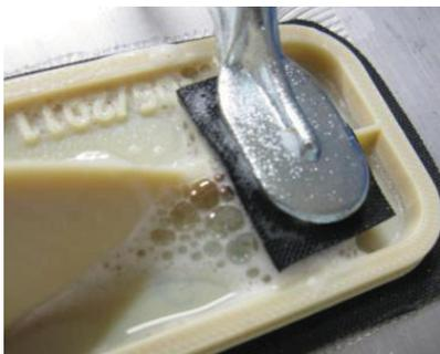
BILD21. Undichtigkeit an einer scharfen Kante durch Seifenlauge sichtbar
