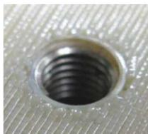
BILD15. Gewindeeinsatz „V-Coil“ in ULTEM 9085 Platte
