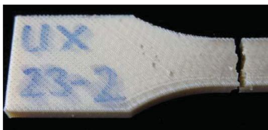
BILD7. Bruchbild Zugprobe PEI „seitlich stehend“
