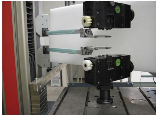
BILD3. Vorrichtung für die Zugprüfung bei Diehl Aircabin
