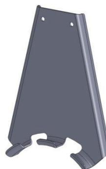
BILD8. Halter A aus Aluminium mit Masse 100g
