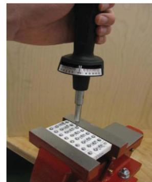
BILD17. Drehmomentschlüssel bei der Ermittlung des Losbrechmoments
