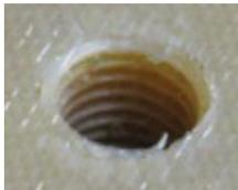
BILD14. Geschnittenes Gewinde in ULTEM 9085 Platte
