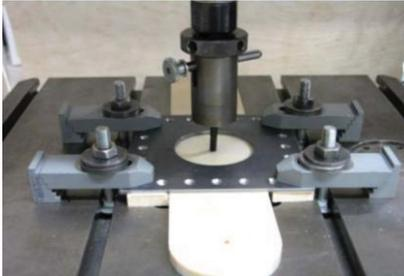
BILD13. Prüfaufbau des Gewindefestigkeitstest
