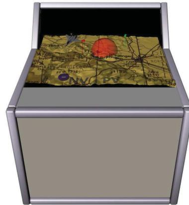
BILD 12 Konzeptskizze einer Arbeitsplatzkonsole, die auf dem Prinzip der Rückprojektion basiert
