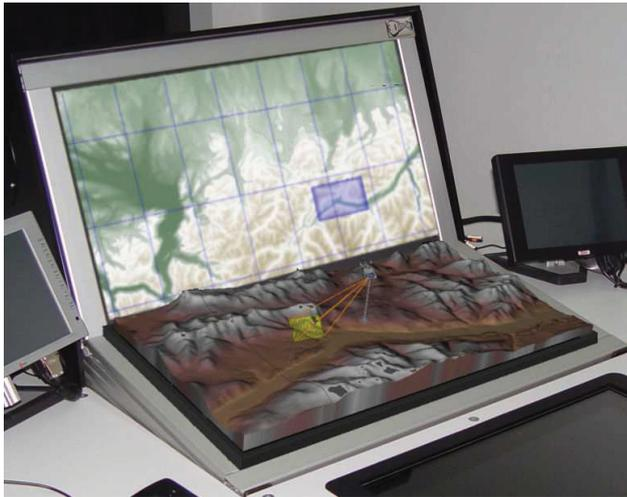
BILD 14 Aufteilung des stereoskopischen Displaybereiches in Übersichts- (oben) und Arbeitsdisplay (unten).
