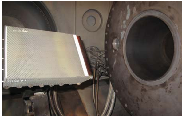
BILD 27. Versuchsaufbau einer C/C-SiC Struktur zur Untersuchung der thermischen Stabilität und thermischen Strömungs-Struktur-Kopplung.
