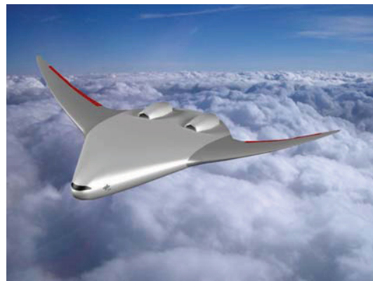
Bild IV-7: Blended Wing Body für das Langstreckenlufttransportkonzept, siehe [16]
