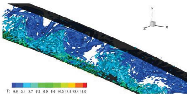
**BILD 5:** Wirbel im Kühlkanal dargestellt durch Isoflächen des sogenannten Q-Kriteriums. Einfärbung der Isoflächen gemäß der lokalen dimensionslosen Temperatur.
