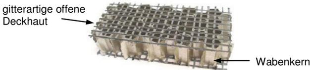
BILD 1. Beispiel einer Sandwichplatte mit gitterartiger Deckhaut
