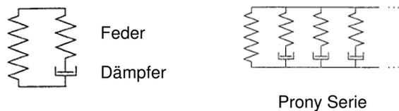
BILD 6. Modellierung des Materialverhaltens von viskos elastischen Material
