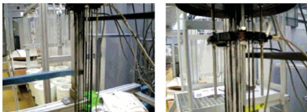
BILD 11. Weiterentwicklung der Flechtpultrusion: Beschichtung von 16 Einzelfäden (links) und Zusatzschlitzscheibe (rechts) [15]
