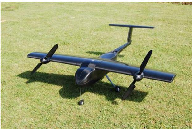
BILD 2. AVIGLE Freiflugversuchsträger
