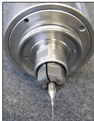
BILD 3. Mikro-Hartmetallbohrer, Durchmesser 60µm
