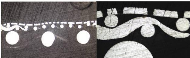
BILD 20. Schliffbild Metall-Außenhaut mit Stützschrift
