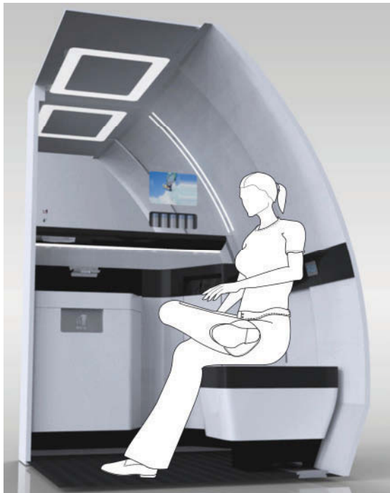
Bild 9: HILA Lavatory mit integriertem Urinal
