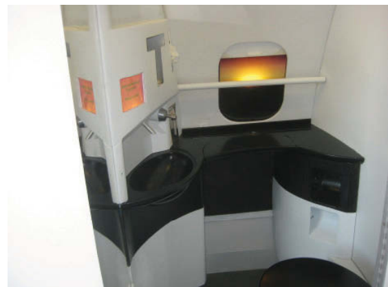
Bild 22: Experimentelles Funktions - Mock up, 1:1 mit Teilfunktionen und Lichtdesign
