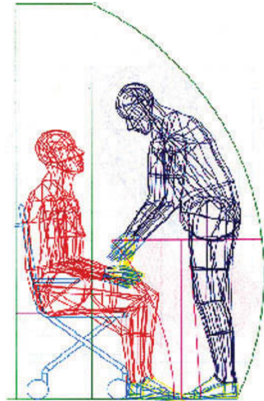
Bild 7: Ergonomieuntersuchung Rollstuhlfahrer Lavatory mit Hilfsperson
