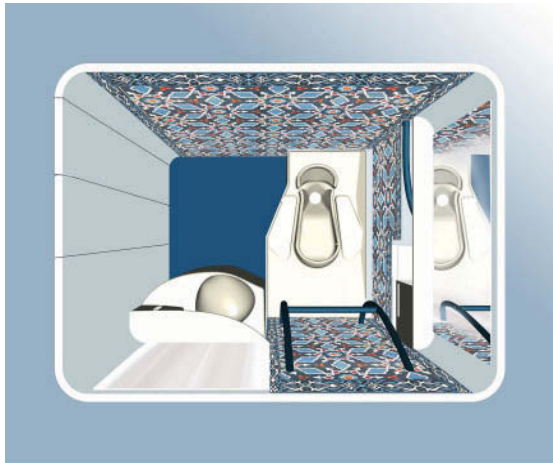
Bild 23: 3D Funktions mock up, 1:1
