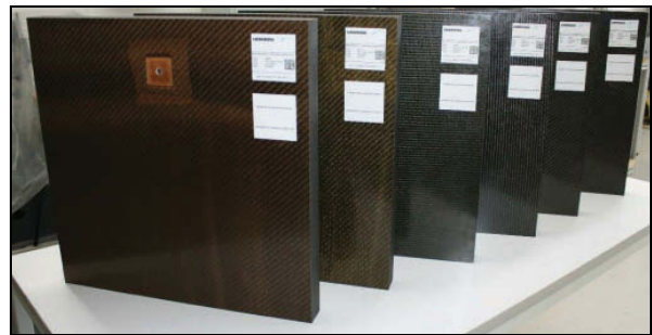
Abb. 3: Probeplatten mit verschiedenem Blitzschutzlagenaufbau
