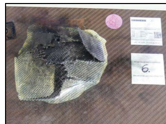
Abb. 4: Beschädigung nach einem Blitztest
