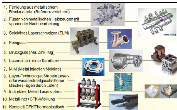
Abb. 6: Zusammenstellung relevanter Fertigungstechnologien für hydraulische Ventilblöcke
