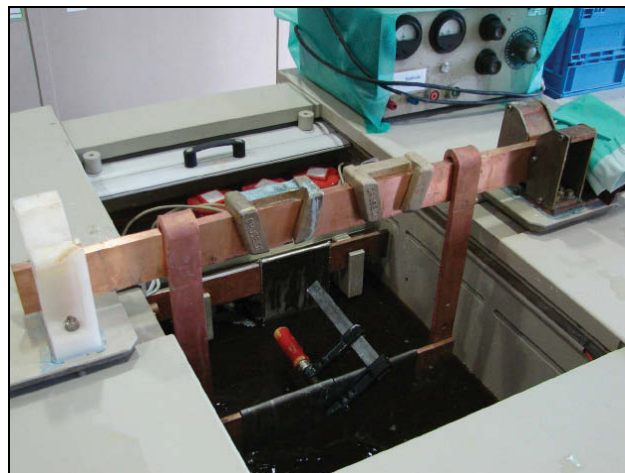
Abb. 1 : Zink-Nickel-Versuchsbad bei Liebherr-Aerospace während der Einfahrphase
