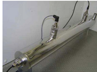
BILD 9. Experimentaleinheit mit zwei UV-Strahlern und nach DVGW W294 geprüften UV-Sensoren
