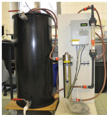
BILD 12. Versuchsanlage zur Untersuchung der Belagbildung. Auf der Rückseite befindet sich ein zweites baugleiches UV-Gerät.
