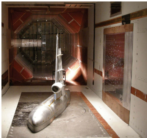
BILD 5. Foto der Messstrecke mit dem Do728 Modell in der Mitte der Messstrecke. Das große Mikrofon-Array ist an der Seitenwand der Messstrecke montiert. Der Blick ist in Strömungsrichtung.
