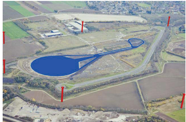
BILD 3. Aldenhoven Testing Center erster Bauabschnitt (blau) mit Illustration der Pseudoliten-Masten (rot)
